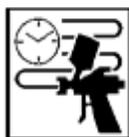
La durata del prodotto catalizzato, ovvero il tempo utile per l'applicazione è di 90 minuti (in Cond. Ambiente); in funzione dell'applicazione si consiglia la preparazione di una quantità adeguata del prodotto in modo da garantirne la lavorabilità ottimale.
